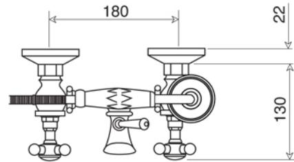
fissaggio a muro
